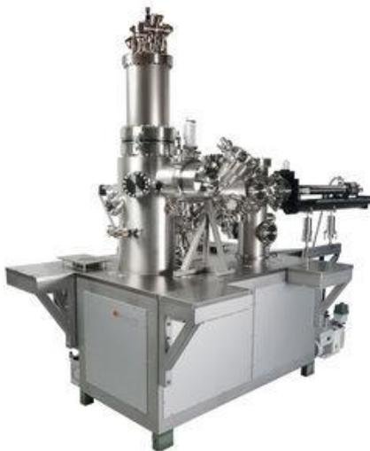
L'ing. Gambardella ci ha raccontato che per studiare il comportamento degli atomi in superficie si ricorre ad uno speciale apparecchio: il *microscopio ad effetto tunnel (STM)*.
